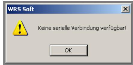
Ist das Nullmodemkabel zum ISM 1 nicht angeschlossen, erscheint die Fehlermeldung „Keine serielle Verbindung verfügbar“.
