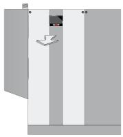
Frontpanel durch Lösen der vier Schrauben abmontieren.
