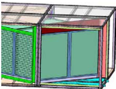
Vestavěný blok desek utěsněte vůči nosnému rámu, podlahové desce, obtokové desce a stropní desce těsnícím materiálem, dodávaným s díly výměníku.
