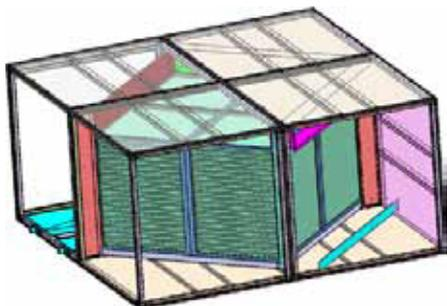
Těsnicí úhelník opatřete těsnícím tmelem a přišroubujte jej k opačné straně odlučovače kapek.
