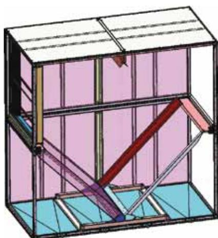
Křížový deskový výměník může být v provedení s anebo bez obtoku (bypass) vzduchu. U provedení „bez“ musí být nyní odstraněny šrouby obtokové klapky. Ty by jinak překážely při vkládání bloků s deskami.
