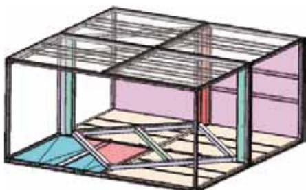
Nosný rám přes otevřenou stranu výměníku vložte na určené místo a podpěry zarovnejte.
