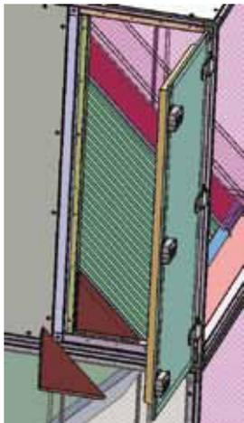
(Volitelně) U provedení s revizními dveřmi je pro zasunutí bloků nutné odstranit také trojúhelníkovou desku, kterou pak po úspěšné montáži je třeba znovu namontovat.
