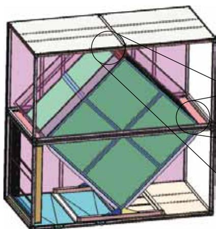
Cirkulační klapku vložte do určité polohy podle obrázku (otvory na výztuhách jsou k dispozici) a přišroubujte ji (provedení na přání).
