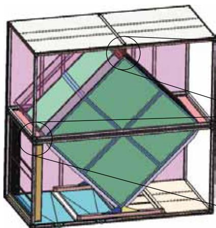
Obtokovou klapku vložte do určité polohy podle obrázku (otvory na výztuhách jsou za tímto účelem k dispozici) a přišroubujte ji.
