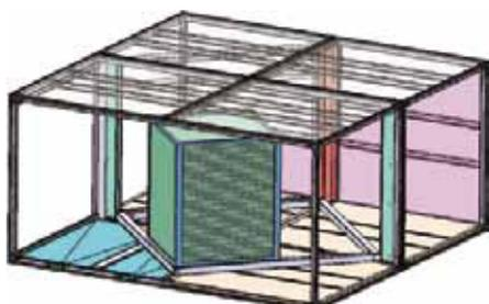
Bloky desek rozbalte a jeden blok po druhém ukládejte na nosný rám, utěsněte je a přišroubujte. Pro usnadnění montáže umístěte jednotlivé bloky (kostky) do koncové polohy až po kompletním sestavení vkládaných bloků.
