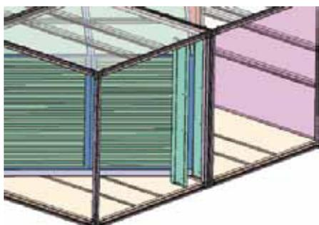
Jednotlivé podpěry znovu našroubujte v místě dělení výměníku.
