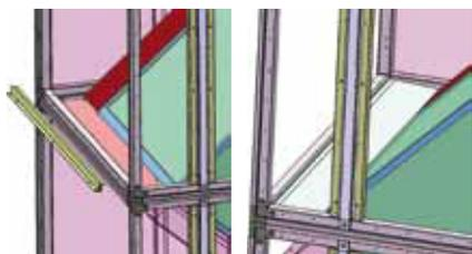
Vyjměte posuvné vodící lišty odlučovače kapek. Dodanou desku pro odvod kondenzátu upevněte na pomocnou výztuhu. Předtím naneste těsnící hmotu podél okrajů desky navazující na namontované bloky. Odtékající kondenzát musí procházet mezi deskami (lamelami) v blocích.
