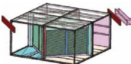
Desky pro obtok znovu namontujte. Vždy na straně odlučovače kapek. U provedení bez cirkulační klapky je třeba nainstalovat další desku proti němu. U provedení s cirkulační klapkou je třeba instalovat proti odlučovači kapek nahoru ještě cirkulační klapku. To je popsáno níže.
