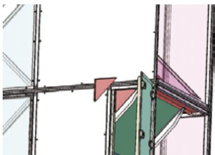
(Volitelně) U provedení s revizními dveřmi je pro zasunutí bloků nutné odstranit také trojúhelníkovou desku, kterou pak po úspěšné montáži je třeba znovu namontovat.
