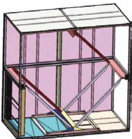
Pokud **není** předpokládána provedení s cirkulační klapkou, je třeba vložit volně dodávanou desku pro obtok mezi zářádky proti straně odlučovače kapek a přišroubovat ji. Stejně jako odlučovač kapek, je i toto připraveno již ve výrobě. Umístěte ji těsně k panelu opláštění.
