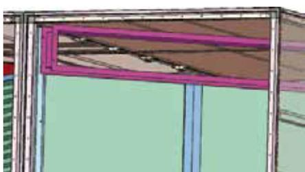
Cirkulační klapku musíte instalovat zcela nahoru na protější straně odlučovače kapek. Polohování se provádí přes otvory v podpěrách.
