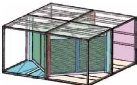
Celý blok desek zasuněte. Blok vyrovnejte podle opěr ve všech 4 rozích. Výztuhu s podpěrami znovu namontujte a přišroubujte.
