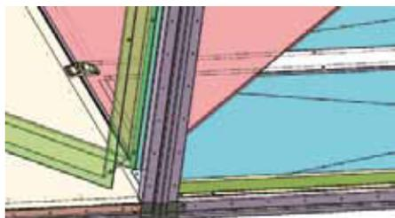
Šrouby pro upevnění klapky odšroubujte (jinak kolidují s bloky desek, které sem budou instalovány). Při špatné přístupnosti může být také panel na straně klapky odmontován.
