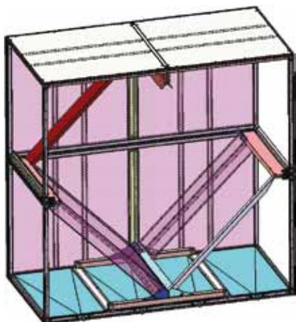
Volně dodanou desku pro obtok vzduchu uložte na stranu odlučovače kapek do správné polohy s opěrkami a přišroubujte ji. Umístěte ji těsně k panelu opláštění.
