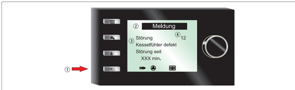
Fig. 11.1 Messaggio di errore sul modulo di visualizzazione AM
